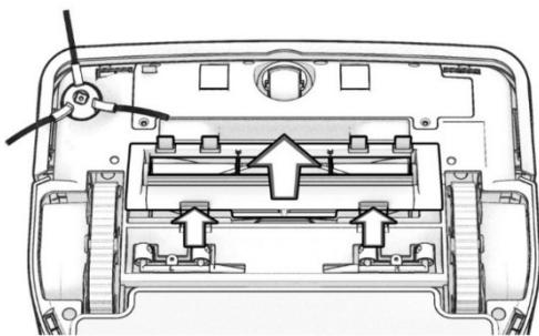
2. Достаньте турбощетку. Затем снимите и очистите подшипник от волос
