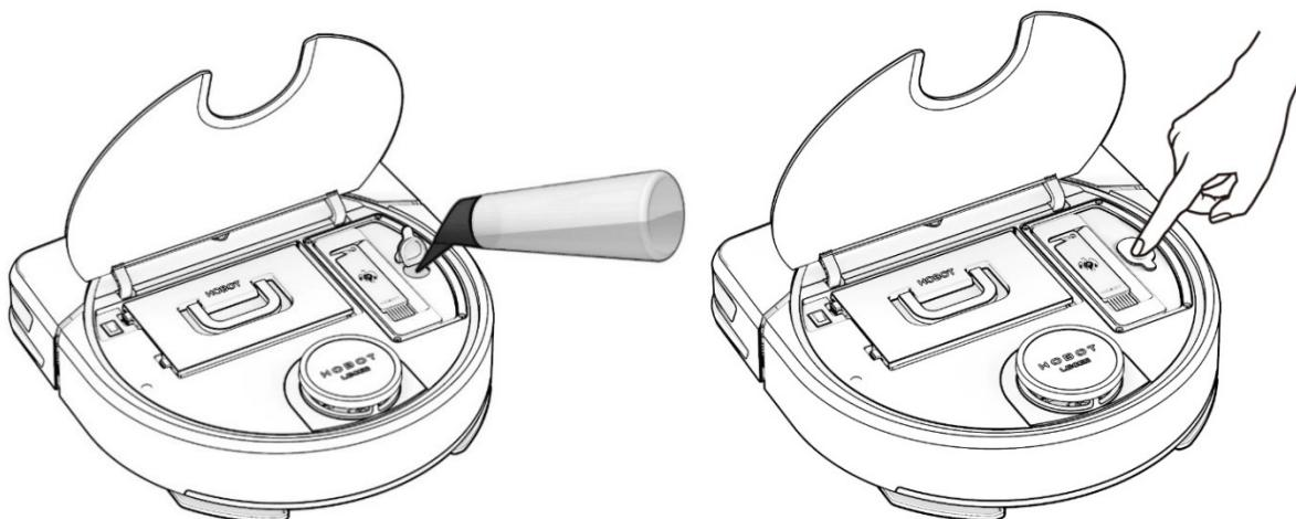
\*Не используйте никакие другие моющие средства или жидкости, чтобы предотвратить засорение (порчу) насоса и распылительных форсунок.
